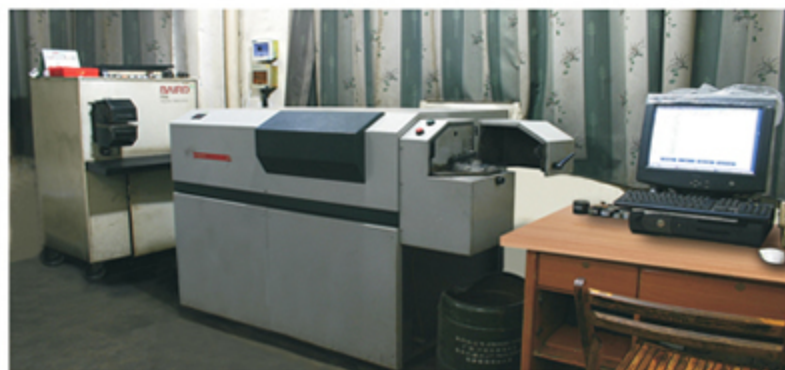
■ 美国、瑞士直读光谱仪，可快速分析高速钢中的W、Mo、Cr、V、S、P、N、Nb等元素含量 American and Swiss spectrometers content of W、Mo、Cr、V、Co、S、P、N、Nb and so on.
